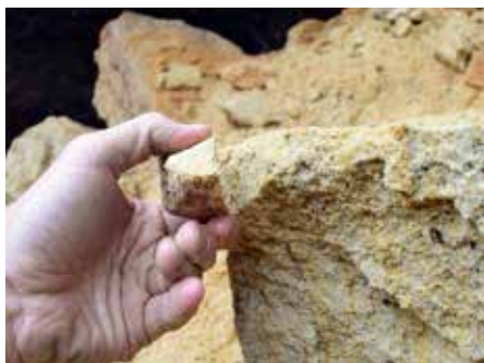
Fot. 9. Z powodu bardzo słabej odporności piaskowca w miejscach świeżego przełamania fragmenty krawędzi bloków można odłamać bez użycia narzędzi (fot. F. Duszyński).
